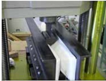
横方向荷重試験装置
